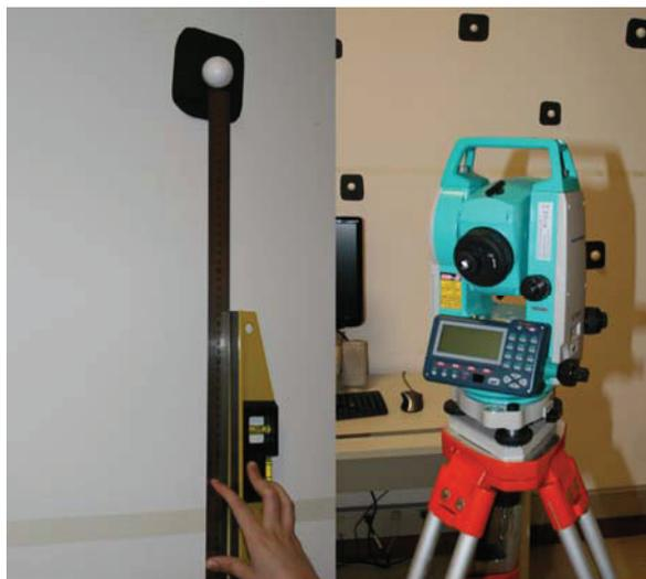
**Figura 4:** Modo de medição simples dos marcadores simples, à esquerda e a estação total à direita.
