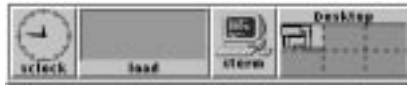
Figura 5: Um FvwmButtons dentro do qual estão, da esquerda para a direita, as janelas dos programas Xclock e Xload, um botão contendo um pixmap e a janela do módulo FvwmPager.
