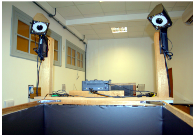
Figura 4.11: Câmeras do sistema de tracking ótico posicionadas para cobrir o espaço interno da MiniCave .
