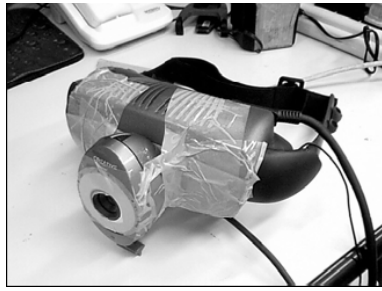
4.2(a): HMD com uma câmera acoplada para permitir AR do tipo Video See-Through .
