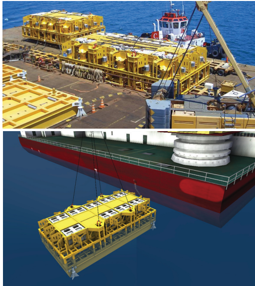
Figura 4. Manifold na balsa de lançamento (em cima) e modelo virtual (embaixo)
