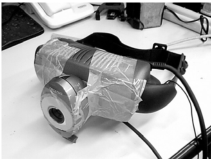
Figura 4. HMD com câmera acoplada para o ambiente de RA.
