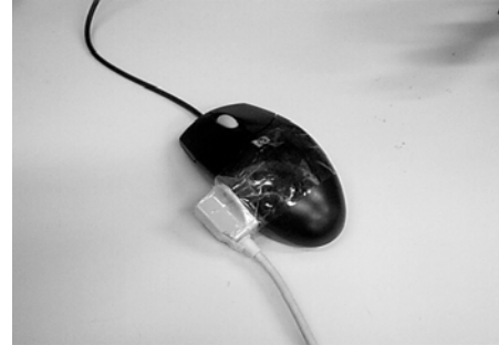
Figura 6. Mouse com um rastreador magnético anexado.
